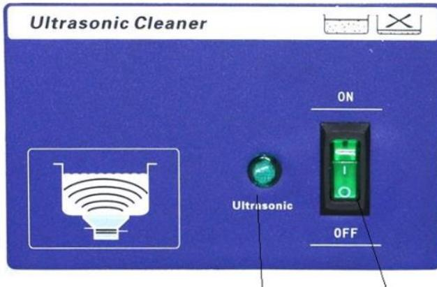
Индикация работы прибора      Вкл/Выкл прибора
