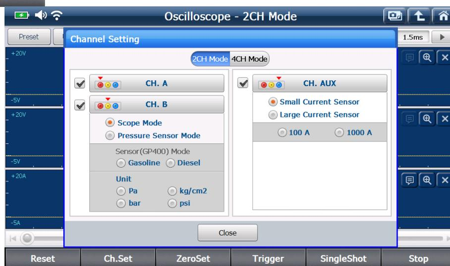
В режиме 2-х каналов, канал "B" может быть переключен в режим осциллографа или режим датчика давления..
