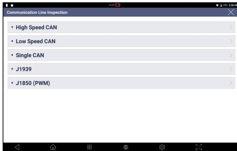
Мигающая контрольная лампа отображает колебания напряжения в линии связи. Посредством проверки линии связи можно проверить линию коммуникации с автомобилем; однако эта функция не измеряет линию связи напрямую. Она косвенно измеряется через основной кабель передачи данных G-scan3, поэтому следует учитывать некоторую разницу в измерении.
